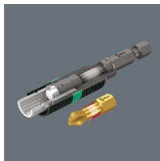
Le curve caratteristiche delle zone di torsione dell'inserto e del porta-inserti sono state sintonizzate al meglio cedendo man mano che il carico aumenta. Questo sistema a due fasi impedisce l'usura precoce. Inoltre si garantisce la lunga durata dell'utensile anche grazie alla durezza dell'inserto adeguata ad ogni tipo d'avvitamento.
