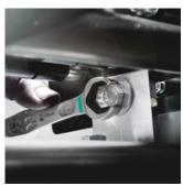
Quando abbiamo iniziato ad occuparci di chiavi di manovra, ci siamo chiesti perché bisognava continuamente invertire la chiave fissa. Perché è a forma di gomito? Perché si perdono in continuazione le viti? Perché si scivola dalla testa della vite, e perché ci si ferisce alle dita? La reinvenzione della bocca della chiave ha portato ad un vero Joker (Jolly) che funziona anche quando non ci sono più altri assi nella manica.
