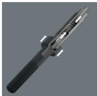
Con l'inserto 4-in-1 9507 possono essere azionate viti esagonali di tre misure diverse (2,5; 5,0; 6,0) e una misura TORX® TX 25. Per utilizzare il profilo più grande, si deve premere durante l'avvitamento continuamente contro la forza della molla, così che il profilo più piccolo sia svasato e possa inserirsi il profilo più grande.
