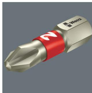
Gli utensili in acciaio inossidabile evitano impropria ruggine. Gli inserti in acciaio Inox della Wera sono temprati sottovuoto a ghiaccio e pertanto dispongono della durezza e resistenza necessarie per gli avvitementi. L'impiego industriale è possibile senza limitazioni.
