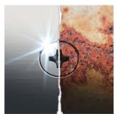
L'acciaio inox non arrugginisce. Ma se per elementi o viti in acciaio inox vengono usati utensili non in acciaio inox, si possono staccare delle particelle che aderiscono sulla superficie e arrugginiscono. Questa cosiddetta ruggine impropria non pregiudica soltanto l'estetica ma può causare anche danni strutturali che richiedono lavori di riparazione a costi non indifferenti. Usando utensili in acciaio inox, si evita l'abrasione di particelle che causano formazione di ruggine impropria.
