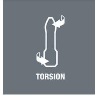
Gli inserti a torsione (T) assorbono i picchi di carico nella zona di torsione. In questo modo si evita l'usura precoce e si allunga la durata dell'inserto.
