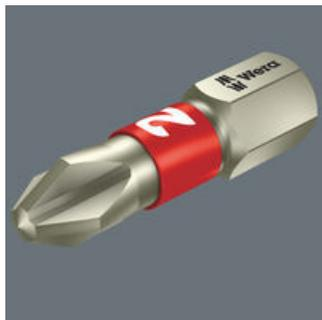
Impiegando gli inserti in acciaio inox si evita la formazione di ruggine sulle viti o sulle superfici in acciaio inox. La ruggine impropria sull'acciaio inox si forma dalle particelle staccatisi dagli utensili in acciaio non inox. Essi si depositano sulla superficie del pezzo e con l'azione dell'ossigeno diventano ruggine.
