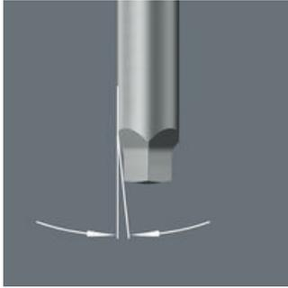
Gli inserti V dispongono di un profilo conico. La risultante forza di bloccaggio trattiene le viti Robertson sulla punta dell'utensile. Ideale per avvitamanti in spazi difficilmente raggiungibili.
