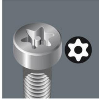
Ideato per impedire lo svitamento non autorizzato delle cosiddette viti antimanomissione. Per impedire l'uso di utensili TORX® convenzionali, sull'impronta della vite si trova un perno sporgente che viene inserito nel foro del TORX® BO permettendo di svitare le viti antimanomissione.
