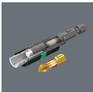
Le curve caratteristiche delle zone di torsione dell'inserto e del portainseri sono state sintonizzate al meglio cedendo man mano che il carico aumenta. Questo sistema a due fasi impedisce l'usura precoce. Inoltre si garantisce la lunga durata dell'utensile anche grazie alla durezza dell'inserto adeguata ad ogni tipo d'avvitamento.
