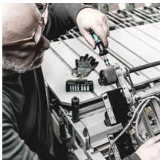
Durante i lavori di montaggio e di manutenzione molti avvitamenti richiedono una coppia ben precisa in modo da garantirne la sicurezza del fissaggio e/o evitare danni alla vite o al pezzo. In questo caso i giravite dinamometrici regolabili della Wera sono gli utensili ideali: intervallo di coppia da 0,3 Nm a 8,8 Nm, tre impugnature diverse, precisione  $\pm 6\%$ , cambio degli inserti ultrarapido grazie al porta-inserti con tecnologia Rapidaptor.
