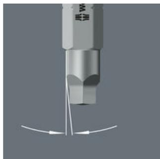
Gli inserti V dispongono di un profilo conico. La risultante forza di bloccaggio trattiene le viti Robertson sulla punta dell'utensile. Ideale per avvitiamenti in spazi difficilmente raggiungibili.
