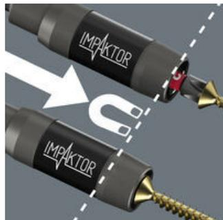
Il portainseriti per avvitatori a massa battente con magnete ad anello riesce a trattenere inoltre viti grandi e pesanti, permettendo un inizio di avvitamento rapidissimo e sicuro. Ideale anche per lavori soprattutto. Se si volesse escludere il magnete, per esempio per gli avvitamenti su metallo, esso potrà essere sfilato dalla zona di avvitamento e quindi "disattivato". Viene impiegato principalmente per avvitamenti con avvitatori portatili.
