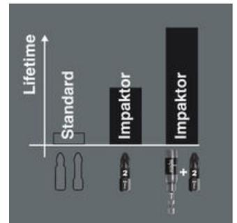
Con una durezza molto elevata. Riduce il pericolo della rottura precoce dell'inserto.
