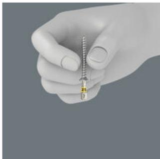
Gli utensili TORX® HF progettati dalla Wera si distinguono per la geometria ottimizzata del profilo TORX® originale. Grazie alla pressione che si genera tra la punta dell'inserto e l'impronta della vite (secondo le previste specifiche tecniche della Acument Intellectual Properties), le viti TORX®, vengono trattenute sull'inserto! Di particolare utilità quando si lavora in ambiti ristretti nei quali non si può usare la seconda mano per trattenere la vite.
