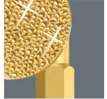
Durante l'avvitamento, le minuscole particelle di diamante si aggrappano letteralmente nella vite e provvedono ad una perfetta accoppiata e tenuta nella testa della vite. In questo modo la vite viene preservata e si riduce la forza di cam-out (scivolare) che costringe l'utente ad esercitare una pressione maggiore sulla vite.
