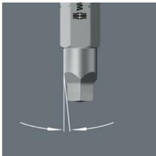
Gli inserti V dispongono di un profilo conico. La risultante forza di bloccaggio trattiene le viti Robertson sulla punta dell'utensile. Ideale per avvvitamenti in spazi difficilmente raggiungibili.
