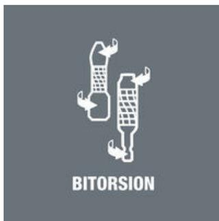
I picchi di carico durante l'avvitamento con avvitatori, spesso portano all'usura precoce dell'inserto o danneggiano la vite. Minimizzando questi picchi, l'avvitamento diventa più produttivo e sicuro. Il sistema BiTorsion della Wera previene l'usura precoce. La longevità dell'utensile viene prolungata e accresce sensibilmente la produttività nell'utilizzo con gli avvitatori.
