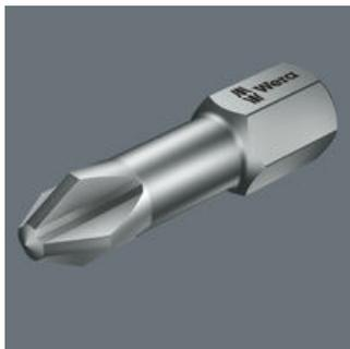
Gli inserti TZ sono inserti duri-tenaci con zona di torsione. Gli inserti a torsione assorbono i picchi di carico nella zona di torsione. In questo modo si evita l'usura precoce e si allunga la durata dell'inser
