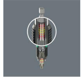
La zona di torsione integrata nel portainseri BiTorsion provvede ad ammortizzare i minori picchi di coppia (fase 1). Un sovraccarico di questa zona viene efficacemente impedito da un meccanismo di sostegno.
