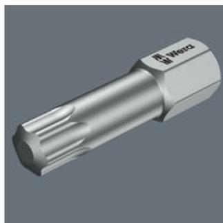
Gli inserti TZ sono inserti duri-tenaci con zona di torsione. Gli inserti a torsione assorbono i picchi di carico nella zona di torsione. In questo modo si evita l'usura precoce e si allunga la durata dell'inserto.
