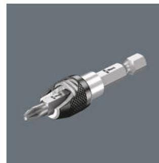
Il portainseri a cambio rapido Wera garantisce una tenuta salda e priva di gioco fra il portainseri e l'inserto. Tirando l'anello di ritegno in avanti si libera il meccanismo di ritegno e l'inserto può essere cambiato rapidamente e facilmente. Modello senza magneti per evitare di ritrarre trucioli di metallo.
