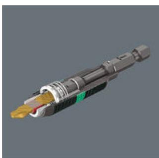
Il sistema di efficacia del sistema BiTorsion si basa sulla combinazione di due elementi ammortizzanti i contraccolpi. Sia gli inserti che i porta-inserti dispongono di una zona ammortizzante, che in caso di picchi di coppia, scarica l'energia cinetica alla punta.
