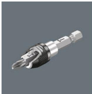
Il porta-inserti a cambio rapido Wera garantisce una tenuta salda e priva di gioco fra il porta-inserti e l'inserto. Tirando l'anello di ritegno in avanti si libera il meccanismo di ritegno e l'inserto può essere cambiato rapidamente e facilmente. Modello con magnete per appoggiare più facilmente le viti.
