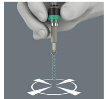
Durante l'avvitamento, l'operatore può guidare l'avvitatore con il manicotto flottante, facilitando la fase iniziale di inserimento della vite e impedendo che l'avvitatore scivoli dalla vite. Da usare anche come prolunga corta in combinazione con attacchi da 1/4", p.es. con il cricchetto Zyklus della Wera.
