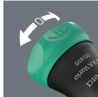
Inversione del meccanismo a cricchetto intuitiva. Ruotare l'interruttore in senso orario per l'avvitamento a destra; ruotarlo in senso antiorario per l'avvitamento a sinistra. Utilizzare la posizione 0 per disattivare il meccanismo a cricchetto per un lavoro preciso.
