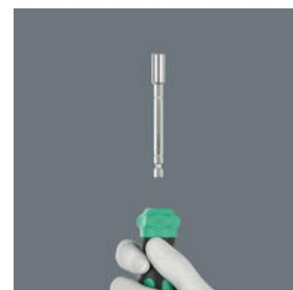
Premendo nuovamente il manico di blocco con più forza, il meccanismo di allentamento viene rilasciato da un superamento chiaramente udibile e tattile della resistenza del blocco. La lama telescopica può essere rimossa e inserita negli avvitatori elettrici come adattatore per inserti.
