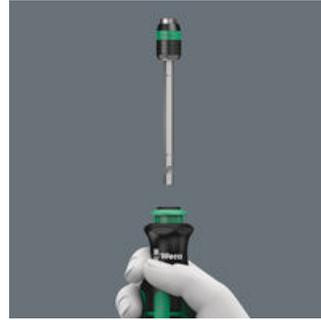
Azionando nuovamente, in maniera più vigorosa, il dispositivo si sblocca la lama. Nel momento in cui la resistenza di bloccaggio cede, si percepirà un segnale acustico udibile e percettibile al tatto. È possibile estrarre la lama ed usarla come adattatore per l'avvitatore o farla rientrare nella posizione originale.
