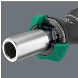
Il cricchetto integrato con dentatura fine consente un lavoro rapido e sicuro. Il meccanismo a cricchetto è interamente integrato nell'impugnatura. La misura ridotta dell'impugnatura permette l'impiego del cricchetto anche in spazi limitati.
