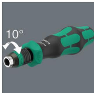
Il cricchetto integrato con dentatura fine (36 denti) e un angolo di richiamo di soltanto 10° semplifica e accelera l'avvitamento senza fastidiose "riprese".
