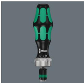
Impugnatura a cricchetto a dentatura fine con un angolo di richiamo ridotto, invertitore (rotazione a destra, al centro bloccato, rotazione a sinistra), coppia massima di 50 Nm; attacco a esagono cavo da 1/4" con tecnologia Rapidaptor con funzioni rapid-in, rapid-out, rapid-spin, chuck-all e uso a una mano sola per cambiare gli inserti in maniera ultra rapida, magnetico, per inserti esagonali da 1/4" secondo DIN ISO 1173-C 6,3 ed E 6,3 e per gli inserti Wera delle serie 1 e 4
