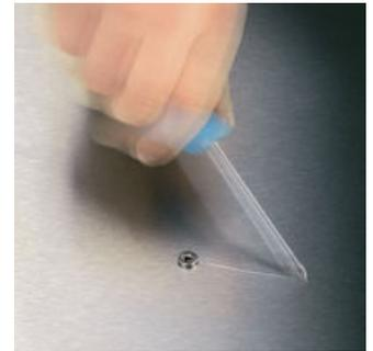
Ripetutamente accade che avvitando si scivola fuori dalla vite. Qualche volta si danneggiano delle pregiate superfici o addirittura ci si ferisce. La punta dei giravite Lasertip della Wera viene irruvidita microscopicamente con dei raggi Laser. Questa superficie ruvida si aggancia letteralmente nella testa della vite. Lo slittamento involontario con ciò può essere evitato.
