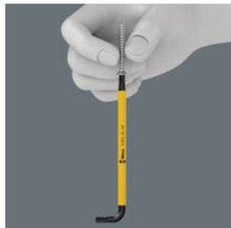
L'impronta TORX® con la particolarità HF della Wera, grazie ad una particolare geometria della lama e la risultante forza di bloccaggio, trattiene le viti TORX® in modo sicuro sulla punta dell'utensile. Ideale per lavori in punti di difficile accesso come p.es. sedi di viti profondamente annegate.
