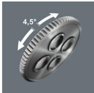
Il cricchetto integrato con dentatura fine (80 denti) e un angolo di richiamo di 4,5° facilita e velocizza l'avvitamento senza il fastidio di un riposizionamento.
