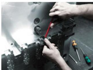
Abbiamo messo in discussione le chiavi a L classiche, perchè troppo spesso durante il lavoro deformano l'impronta nella testa della vite. Con la conseguenza, che le viti non possono più essere azionate, e che la chiave slitta. Gli utensili Hex-Plus della Wera dispongono di superfici d'appoggio maggiori sulla testa della vite. L'effetto di intaglio e la conseguente deformazione della vite viene ridotta. Inoltre si possono trasmettere coppie maggiori del 20%.
