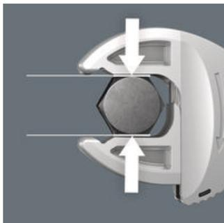
Le ganasce parallele e lisce consentono una pressione superficiale, evitando così lo stondamento dei dadi o della testa delle viti, quando subentra la trasmissione di forza sugli angoli.
