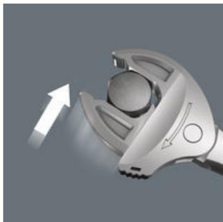
Con le sue ganasce parallele che si bloccano automaticamente e continuamente, la Joker 6006 copre tutte le dimensioni all'interno del range operativo potenziale. L'utensile trova da solo la dimensione richiesta quando viene fissato al dado o alla vite.
