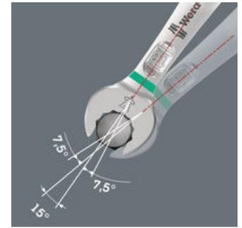
Grazie all'inclinazione di  $7,5^\circ$  della forchetta, alla geometria a doppio esagono e alla modalità di impiego adattata (posizionamento - avvitarlo - rotazione - nuovo posizionamento - avvitarlo etc.) possono essere risolti problemi di avvitarlo, che consentono un angolo di rotazione inferiore a  $30^\circ$ .
