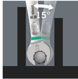
La chiave a doppia forchetta Joker 6005 con la sua speciale geometria, la sua inclinazione sul lato forchetta di  $7,5^\circ$  e la geometria a doppio esagono - raddoppia la possibilità di impiego ruotando ripetutamente la chiave di  $180^\circ$  sull'asse longitudinale. Dadi e viti possono essere orientati di  $15^\circ$ . Il Joker 6005 trova da solo, per così dire, il rispettivo punto di applicazione dopo ogni inversione.
