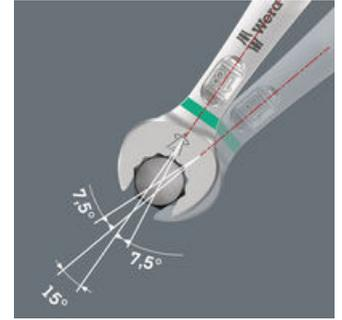
Grazie all'inclinazione di 7,5° della forchetta, alla geometria a doppio esagono e alla modalità di impiego adattata (posizionamento - avvitamento - rotazione - nuovo posizionamento - avvitamento etc.) possono essere risolti problemi di avvitamento, che consentono un angolo di rotazione inferiore a 30°.
