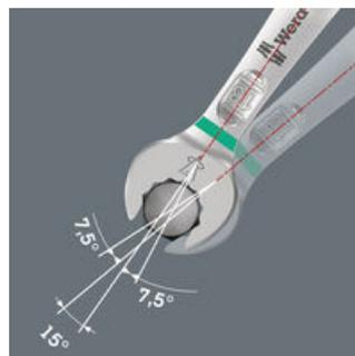
Grazie al lato a forchetta orientabile di 7,5°, alla geometria a doppio esagono e a un metodo di applicazione adattato (appoggio, avvitatura, rotazione, riappoggio, avvitatura, rotazione, ecc.), possono essere utilizzati anche in caso di avvitiamenti in cui l'angolo di manovra è inferiore a 30°.
