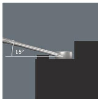
Il lato poligonale è inclinato di 15° rispetto all'asse dell'utensile per evitare lesioni.
