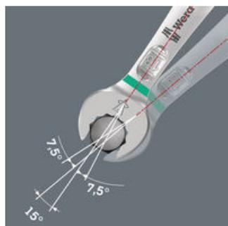
Grazie al lato a forchetta orientabile di 7,5°, alla geometria a doppio esagono e a un metodo di applicazione adattato (appoggio, avvitatura, rotazione, riappoggio, avvitatura, rotazione, ecc.), possono essere utilizzati anche in caso di avvitamenti in cui l'angolo di manovra è inferiore a 30°.
