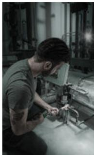
Chiave dinamometrica Click-Torque X 7 con attacco per utensili intercambiabili 14x18 mm
