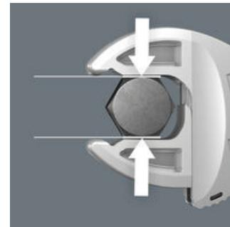
Le ganasce piatte parallele del Joker 7880 consentono una pressione superficiale, evitando così lo stondamento dei dadi o della testa delle viti, quando subentra la trasmissione di forza sugli angoli.
