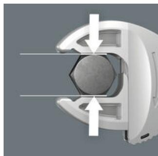
Le ganasce parallele e lisce della chiave Joker 6004 VDE consentono la pressione sulla superficie e possono quindi impedire danneggiamento del dado o della testa della vite, che può verificarsi quando la potenza viene trasmessa sugli spigoli.
