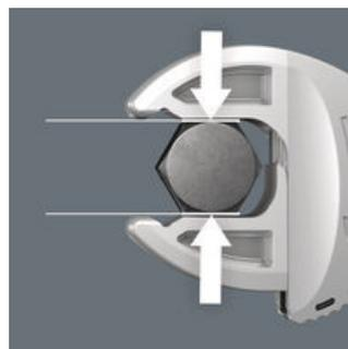
Le ganasce parallele lisce del Joker 6004 consentono una pressione della superficie e di conseguenza impediscono lo smussamento della testa della vite o del dado, cosa che può succedere attraverso la trasmissione della forza sugli angoli.
