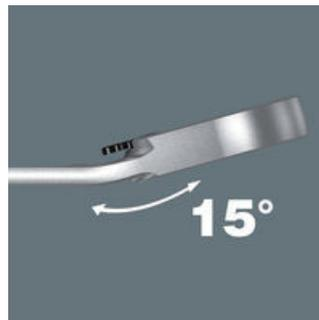
L'estremità ad anello si trova ad un angolo di 15° rispetto all'asse dell'utensile per facilitare il posizionamento della chiave in spazi ridotti.
