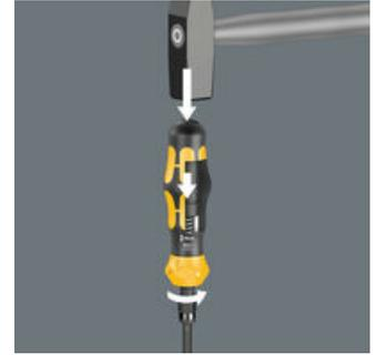
Quando la funzione giravite a battere è attivata, l'impulso del colpo di martello viene convertito in un movimento rotatorio con una coppia di allentamento fino a 25 Nm. La potenza viene trasmessa senza perdite tramite una lama passante.
