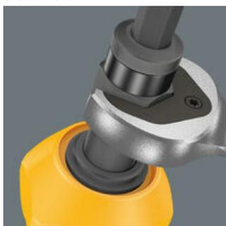
Con la funzione a battere disattivata, per una maggior trasmissione di forza, è possibile azionare il supporto della chiave con una chiave a forchetta da 13 mm.
