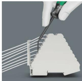
Le morsettiere trattengono meccanicamente le estremità dei fili. La forza necessaria per ciò è fornita da una molla. La molla deve essere aperta da un utensile per poter inserire le estremità del filo. Gli speciali utensili per connettori della Wera consentono l'azionamento dei morsetti a molla, anche in spazi ristretti nei quadri elettrici. La lama curva consente inoltre di raggiungere i morsetti a molla dove non è possibile utilizzare utensili a lama dritta.
