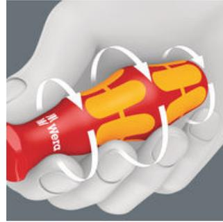
I materiali duri dell'impugnatura permettono il cambio rapido della presa senza che la pelle rimanga attaccata all'impugnatura. Le zone più morbide, "antiscivolo", facilitano una efficace e confortevole trasmissione della forza di torsione.
