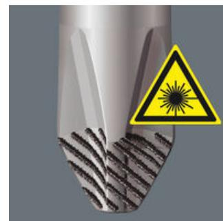
Tramite un raggio laser concentrato, si crea una superficie di strutturazione a spigolo vivo. La lama Lasertip della Wera si aggancia saldamente nella testa della vite evitando che ne slitti fuori. Adatto per viti a taglio, Phillips e Pozidriv.
